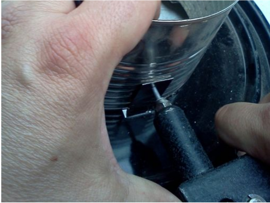
Align Rivet & Push
