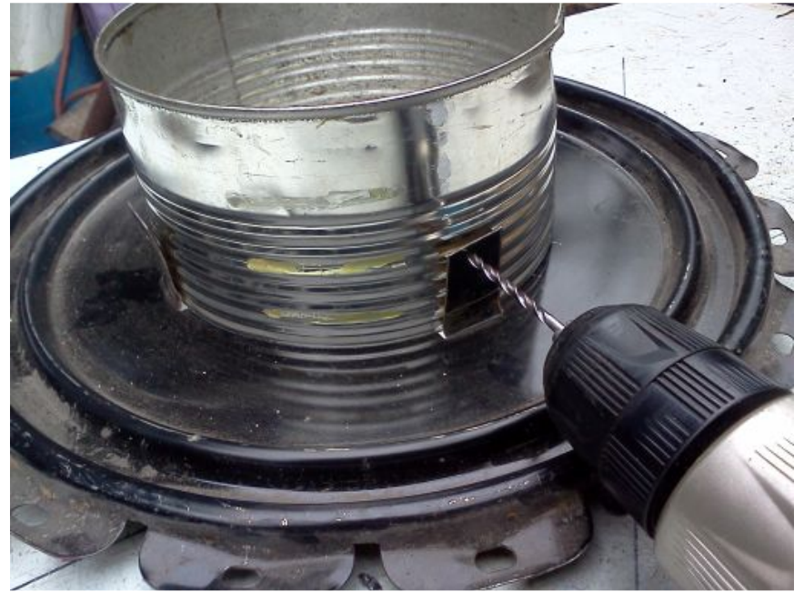
Drill Tin Lid Rivet Hole
